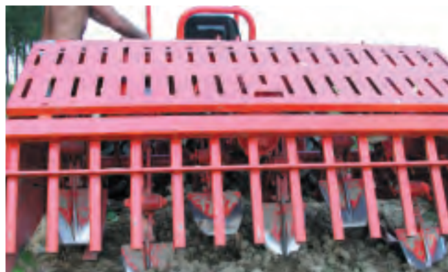
La vangatrice, macchina che ha permesso di accantonare l'uso dell'aratro e che non produce suola di lavorazione, in quanto strappa la zolla di terreno invece di tagliarla
